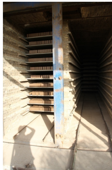
شکل ۳-۴: خشک کردن خشت‌ها با قرارگیری در سالن‌های مربوطه (سمت راست) و فن‌های گردش هوا درون آن (سمت چپ)
