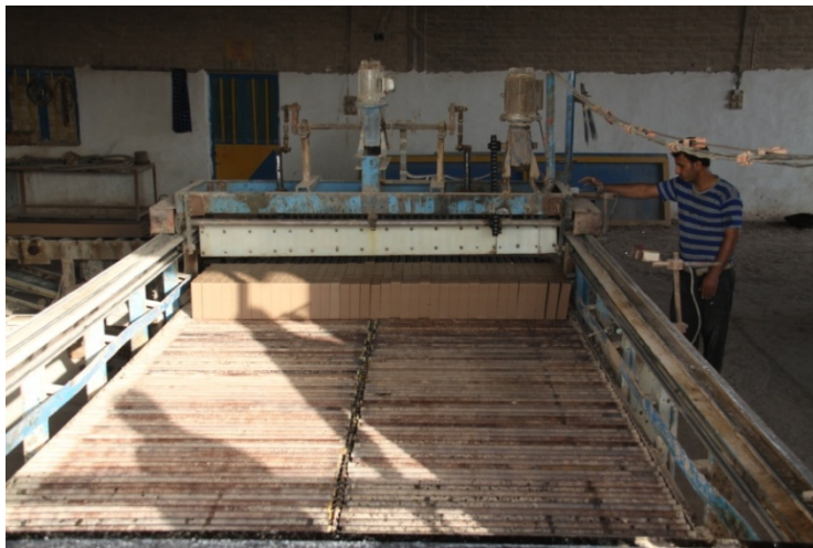
شکل ۴-۱: گِل قالب‌گیری شده در حال حرکت به سمت دستگاه برش (بالا) و خشت تولیدشده از برش آن (پایین)
