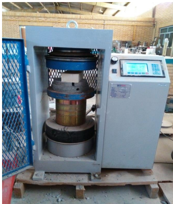
شکل ۲-۳: دستگاه تست استحکام آجر
