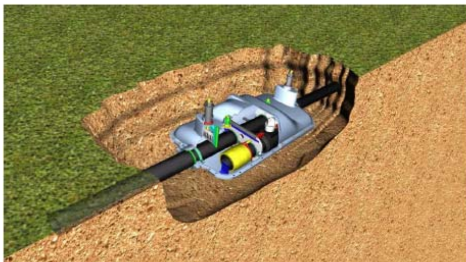
شکل ۳.۵: نمایی از تعمیر لوله‌های پلی اتیلنی به وسیله MAGIC BOX™
