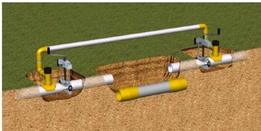
شکل ۲.۵: نمایی از تعمیر لوله‌های پلی اتیلنی به روش معمول
