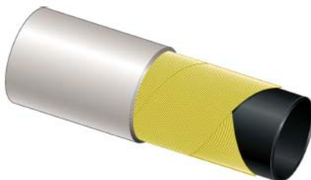
شکل ۱.۵: لایه‌های مختلف لوله‌های RTP
